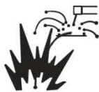
●焊接产生的飞溅、打磨作业产生的铁粉进入电源内部，会导致焊机内部品的绝缘恶化，引起火灾。
